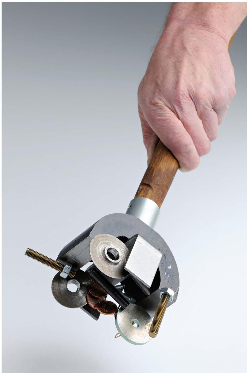
Magnete und Magnetsysteme von TRIDELTA basieren auf einer jahrzehntelangen Produktionserfahrung der Thyssen Magnetfabrik. So auch die magnetischen Badgreifer, die speziell für galvanische Bäder, Härtereien, Beiz- und ähnliche Betriebe entwickelt wurden.
