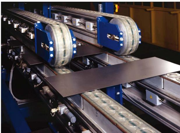
Der Magnet-/Vakuum-Zahnriemenförderer ist ein kombinierter Förderer für den aufliegenden und hängenden Transport von plangerichteten magnetischen und nicht magnetischen Platinen.
