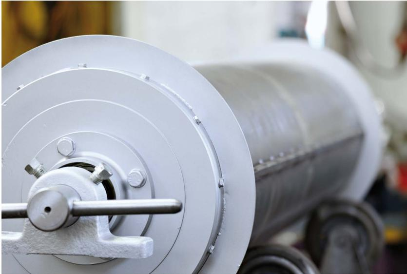
Permanentmagnetische Separationswalzen bestehen aus einem feststehenden Magnet-system. Dieses wirkt je nach Größe auf einen Winkel von  $120^{\circ}$ - $270^{\circ}$ , so dass eine ausgeprägte nichtmagnetische Zone entsteht.
