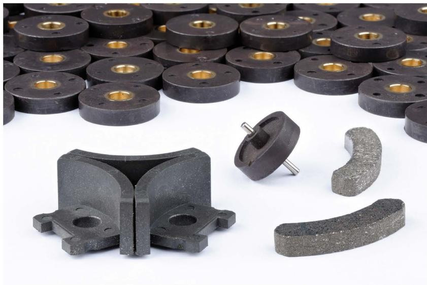
Aus unseren Werkstoffpulvern von Neolit und Oxit stellen wir kunststoffgebundene Magnete her. Diese Magnete können durch ein Pressverfahren hergestellt werden, in dem die Legierungspulver mit Kunstharz gemischt und verpresst und dann bei ca. 150°C ausgehärtet werden.
